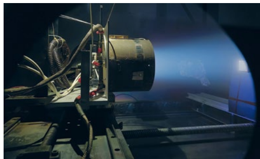
Links: Laserspektroskopische Untersuchung an einem mit Xenon betriebenen RIT-10 EVO (bereitgestellt durch ArianeGroup GmbH) in einer Vakuumkammer am IOM Leipzig. (Foto: Lukas Pietzonka) Rechts: IOM-Experte Dr. Daniel Spemann
