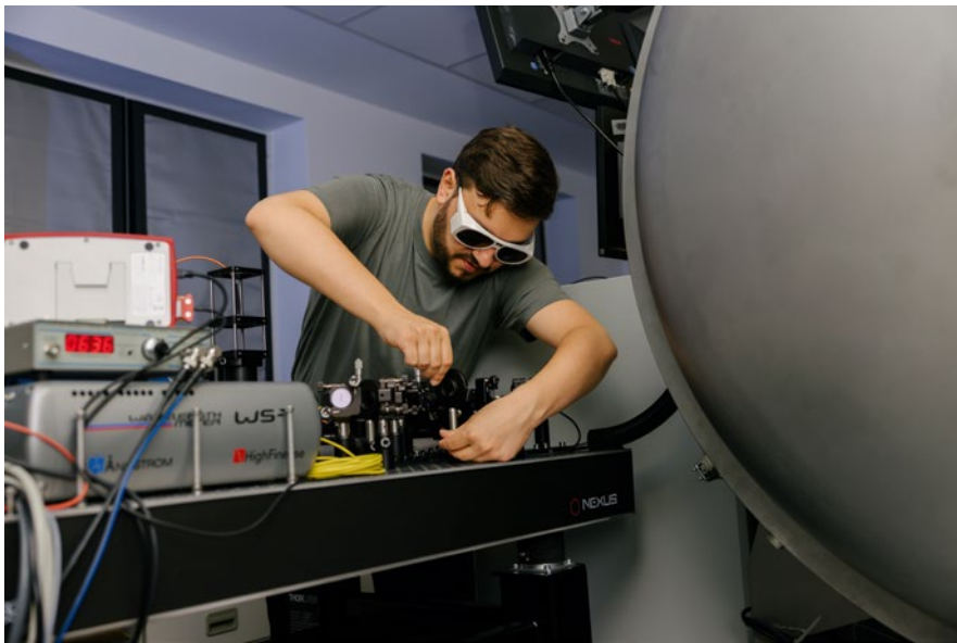
Lukas Pietzonka, wissenschaftler Mitarbeiter, bei der Justage der optischen Komponenten für die laserinduzierte Fluoreszenzspektroskopie. Foto: Erik Kazak
